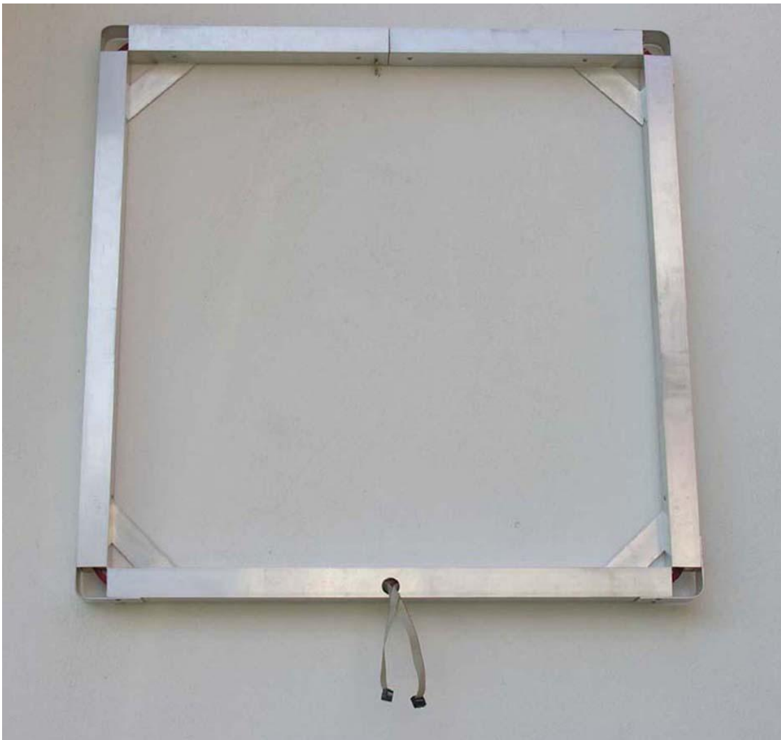
Foto dell'antenna e dell'uscita dell'avvolgimento realizzato con nastro di dieci fili accoppiati
