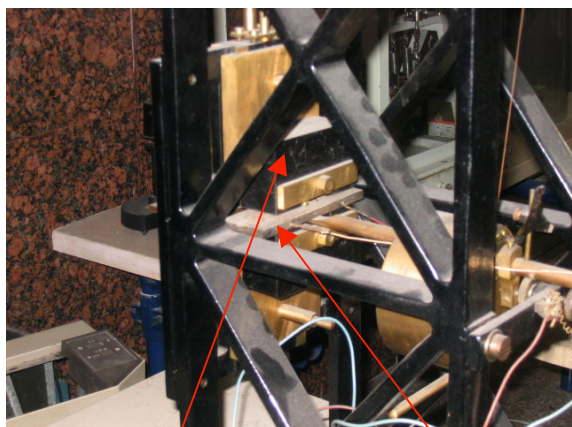
Fig. 2.4.1 – Particolare Galitzin: Bobina e magneti.
