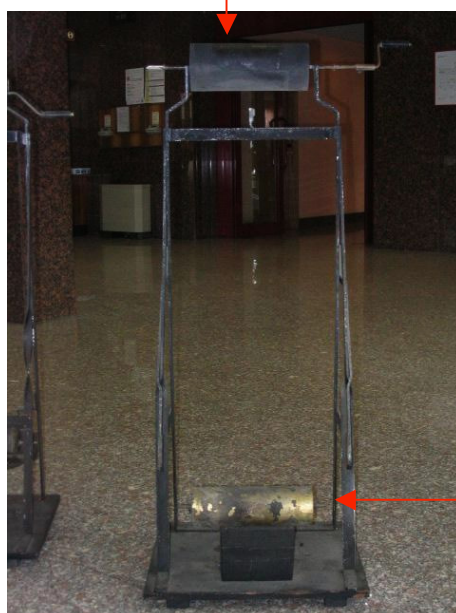
Fig. 2.2.1 – Dispositivo per affumicatura dei fogli.
