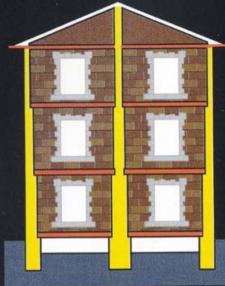
Alle oscillazioni resistono soprattutto gli elementi strutturali degli edifici: solai e travi (orizzontali), pilastri (verticali).
