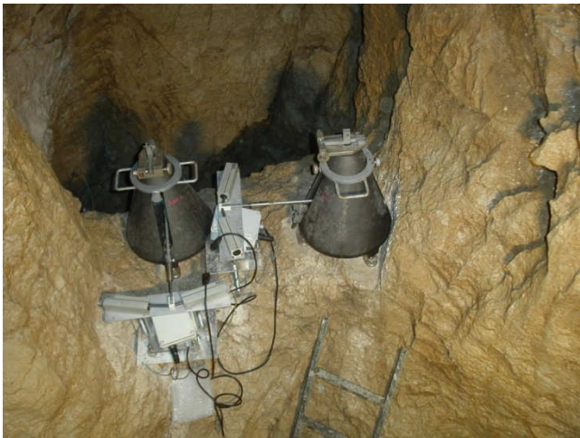
Fig. 2- La coppia di clinometri e il rilievo dei primi 45 metri del Bus de la Genziana.
