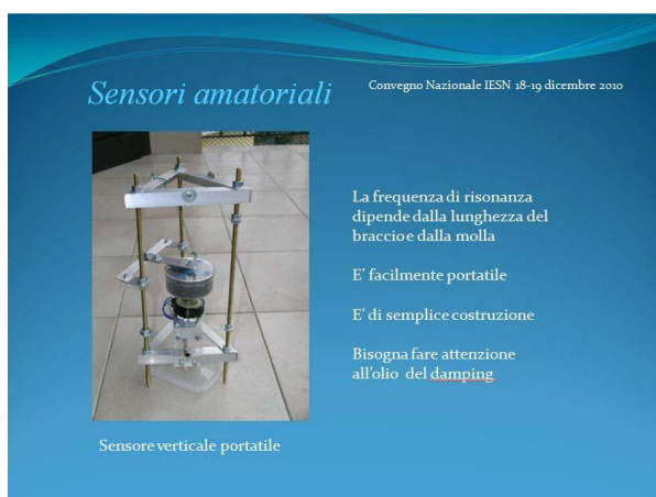
Un'immagine della presentazione sui sensori sismici auto costruiti di Riccardo Rossi
