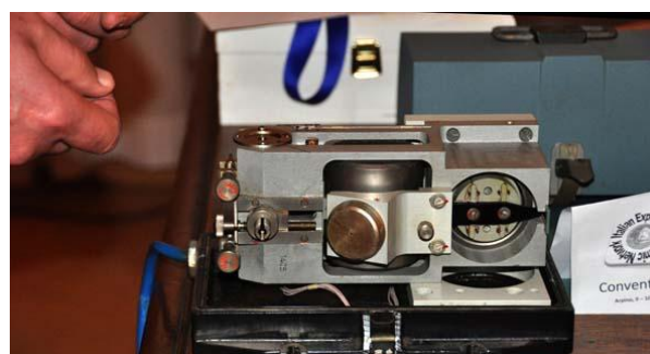
Un sensore orizzontale/verticale a 2 sec di periodo di risonanza, di produzione russa acquistato da Paolo Frediani
